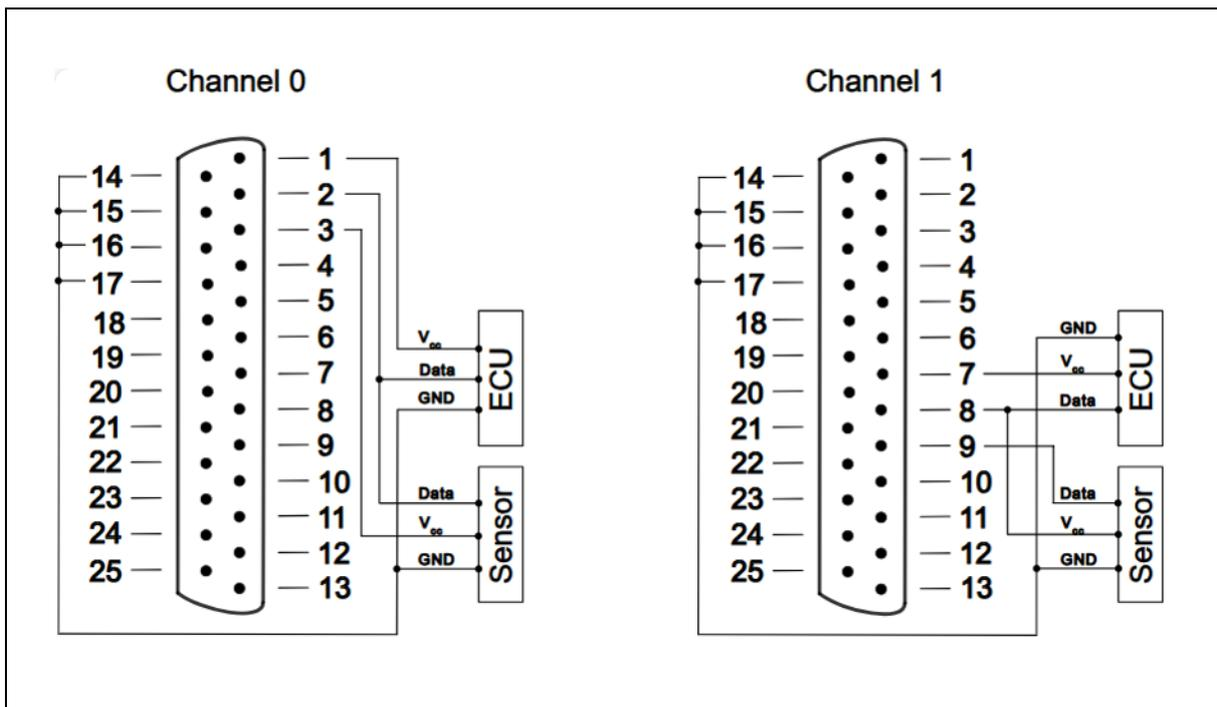
Abb. 12 Verdrahtung Passiv-Mode
