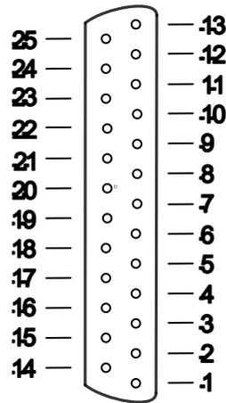
Abb. 4 Analog/Digital IO - Pinbelegung
