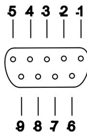
Abb. 2 CAN-Interface Pinbelegung
