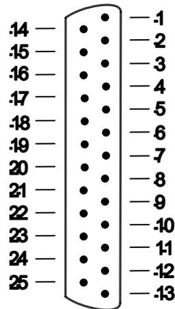
Abb. 3 Sensor/ECU IO - Pinbelegung
