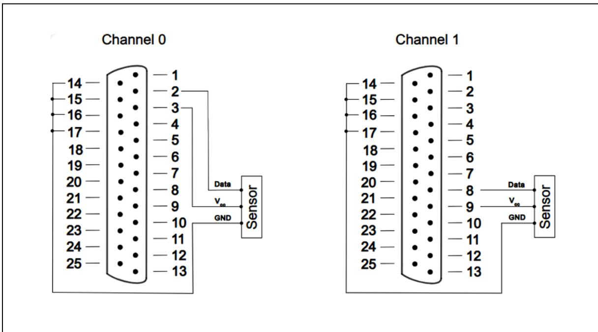
Abb. 8 Verdrahtung ECU-Mode
